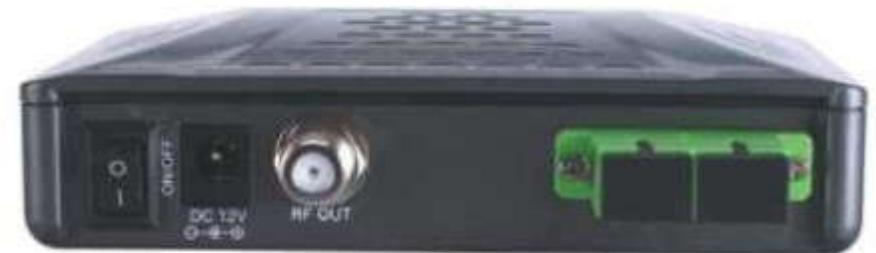
Este mini Receptor permitirá ver Televisión en 1550nm, pero tiene una alternativa de paso óptico para instalar una ONU a futuro.
